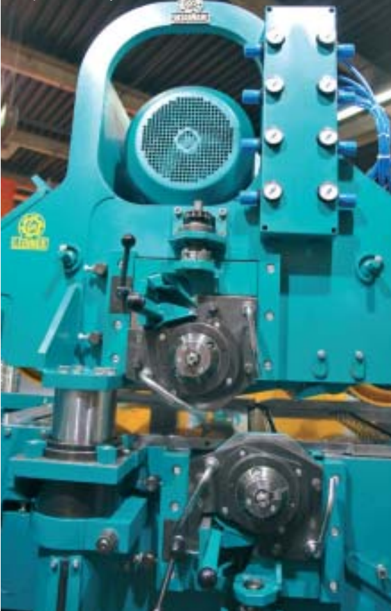
Строгальный узел и гидравлический зажим стойки
