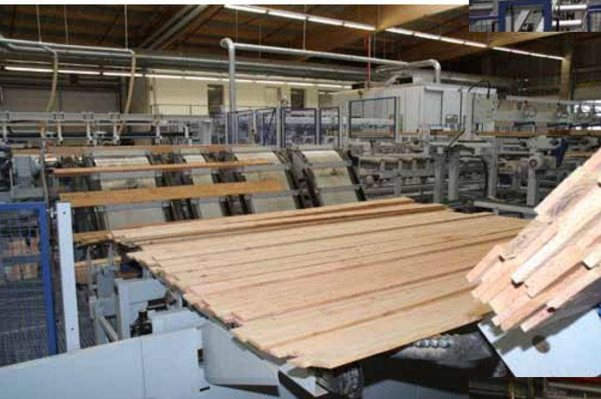
*Нет чувствительности к сбоям: вакуумная разборка штабеля с разобщением по слоям и бережной транспортировкой на станцию сортировки*
