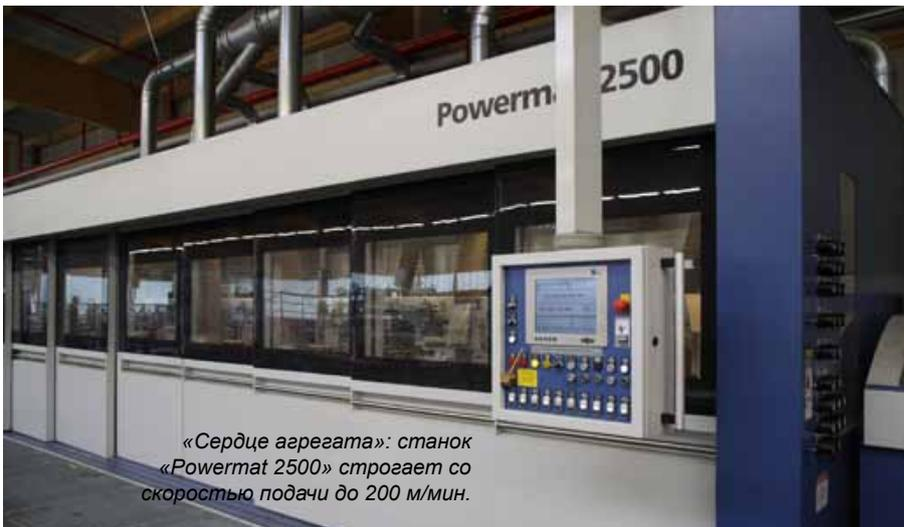
«Сердце агрегата»: станок «Powermat 2500» строгает со скоростью подачи до 200 м/мин.
