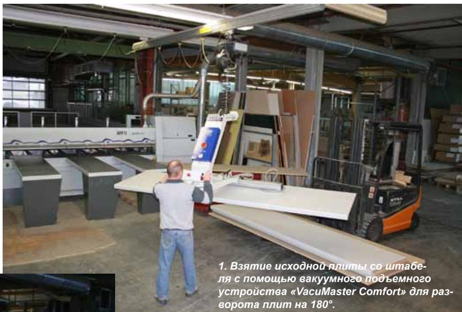
1. Взятие исходной плиты со штабеля с помощью вакуумного подъемного устройства «VacuMaster Comfort» для разворота плит на 180°.
