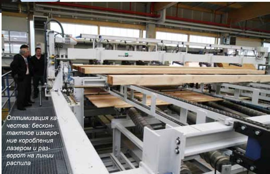
*Оптимизация качества: бесконтактное измерение коробления лазером и разворот на линии распила*
