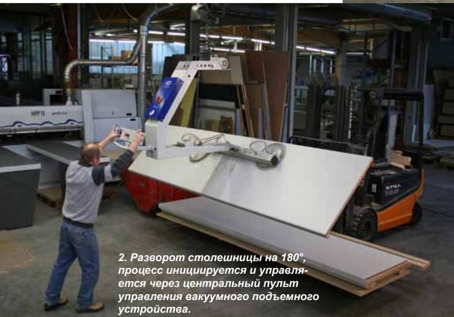
2. Разворот столешницы на 180°, процесс инициируется и управляется через центральный пульт управления вакуумного подъемного устройства.
