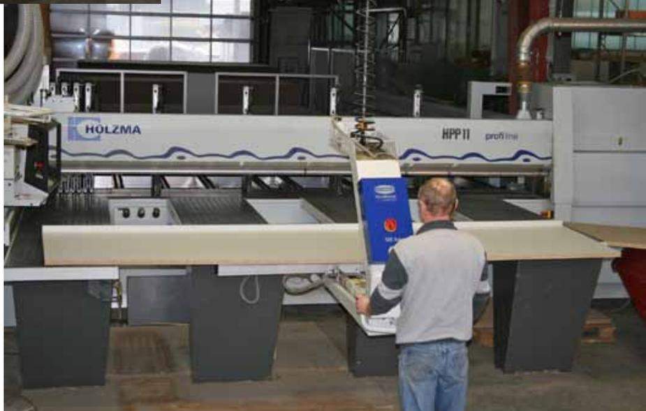
3. Укладывание заготовки столешницы на стол машины раскройного станка ЧПУ.
